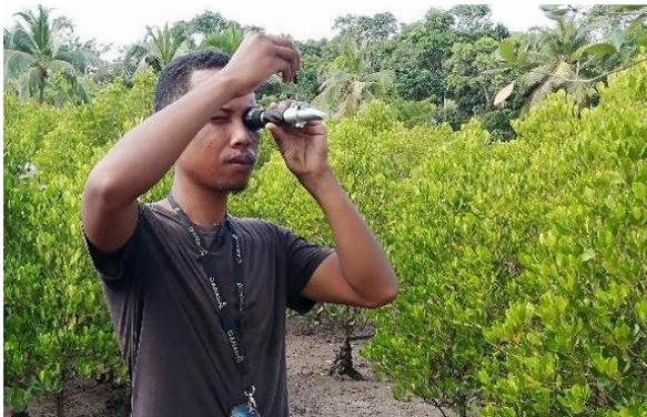
Photo 12. Capture de la salinité par le réfractomètre
